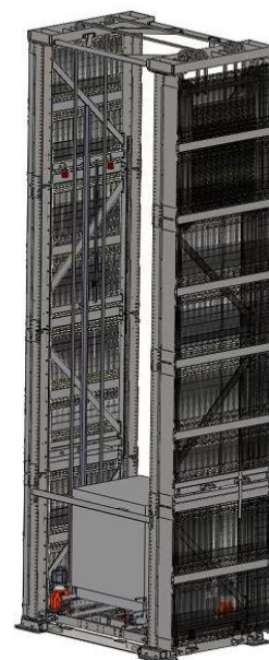
图 4-3 齿轮齿条式提升机
